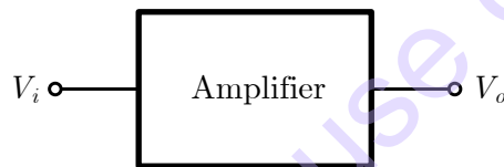
รูปที่ 4.1 โครงสร้างโดยทั่วไปของวงจขยายสัญญาณ
